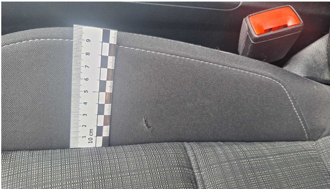
Bild 35 Innenraum Sitz vorne links gerissen / eingerissen
