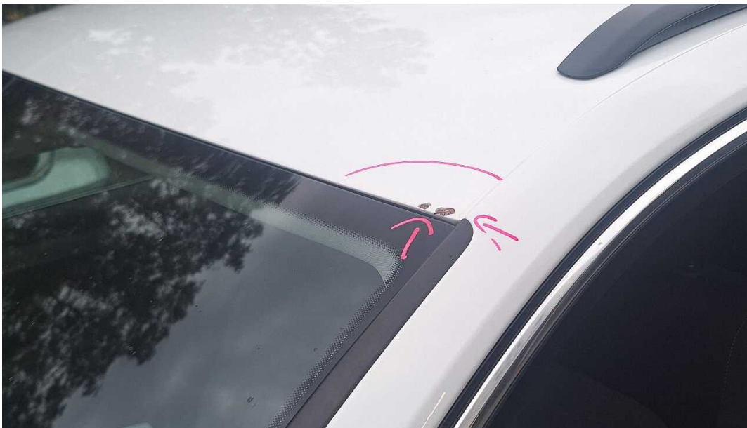
Bild 30 Dach Dachhaut korrodiert
