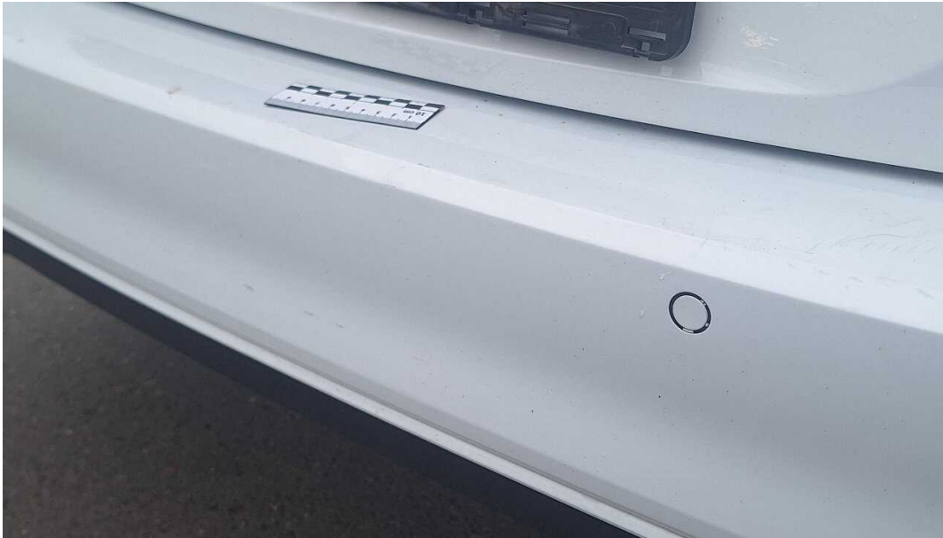
Bild 25 Fahrzeugheck Stoßfänger hinten verformt
