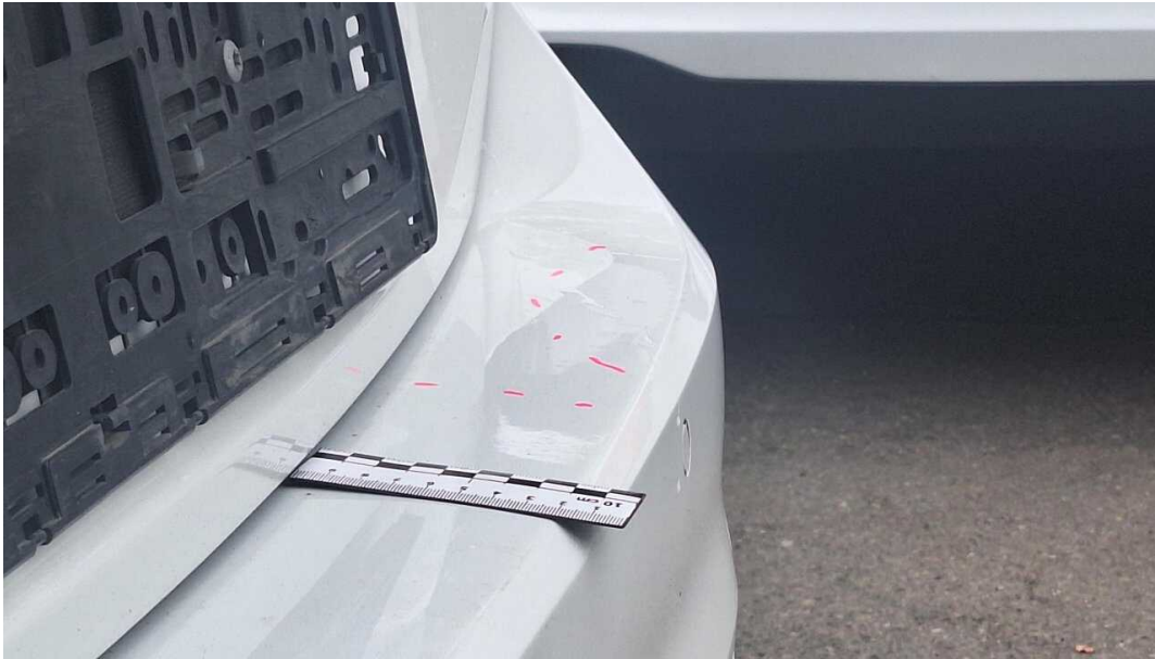
Bild 27 Fahrzeugheck Stoßfänger hinten verformt
