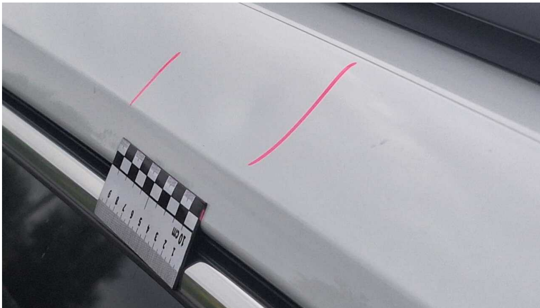
Bild 24 Dach Dachholm rechts Dellen
