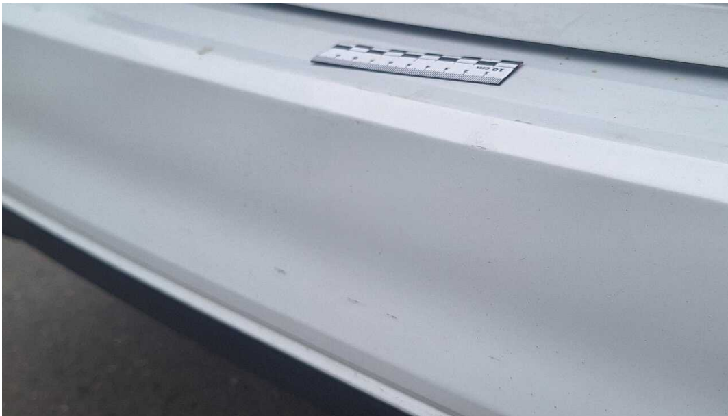
Bild 26 Fahrzeugheck Stoßfänger hinten verformt
