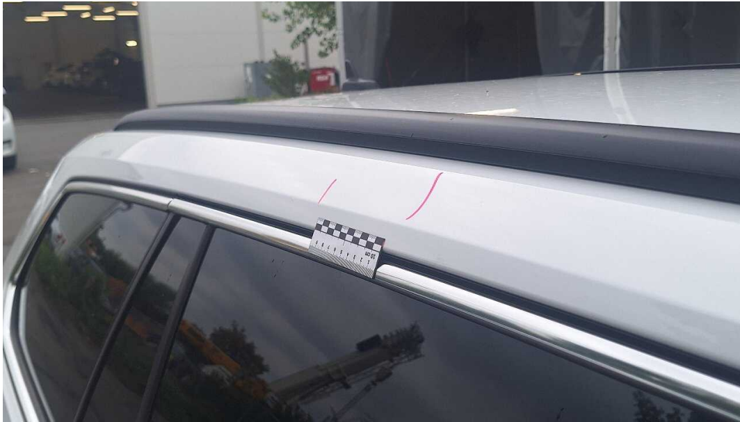
Bild 23 Dach Dachholm rechts Dellen
