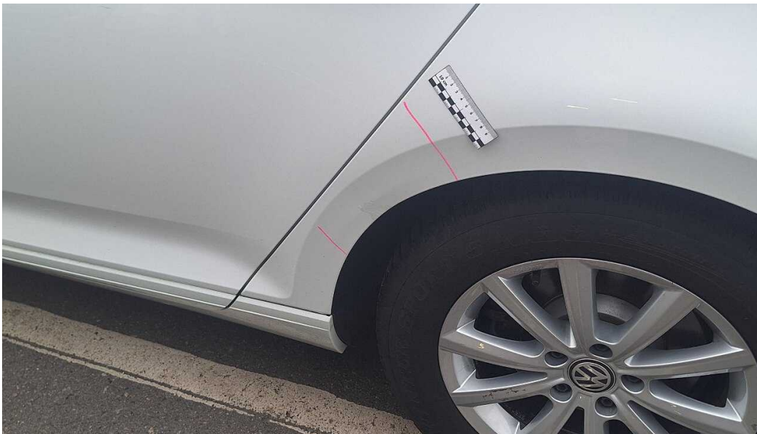
Bild 28 linke Seite Seitenteil hinten links deformiert
