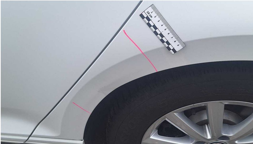
Bild 29 linke Seite Seitenteil hinten links deformiert
